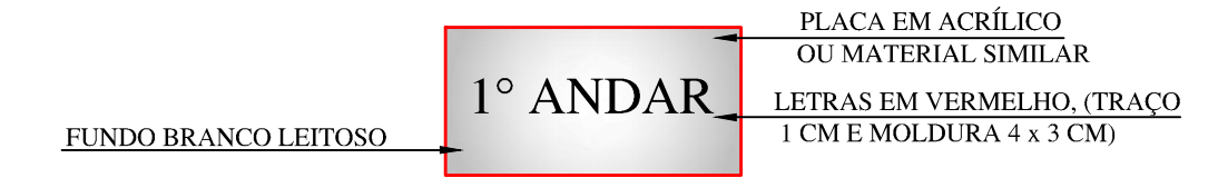
PLANTA PLACA INDICATIVA DE PAVIMENTO
