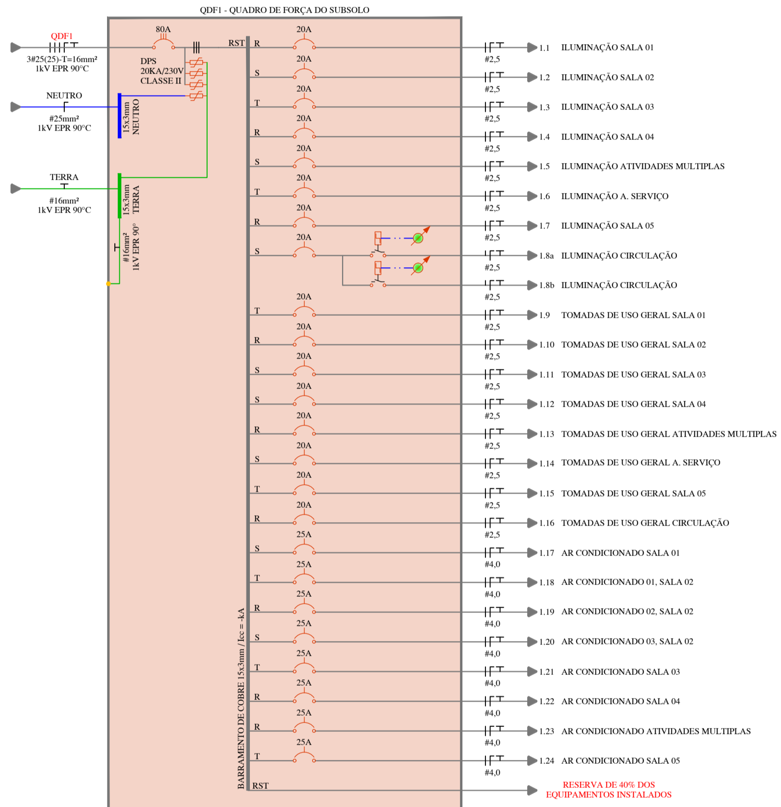
DIAGRAMA UNIFILAR QDF1 - QUADRO DE FORÇA DO SUBSOLO ESCALA: S/ESC
