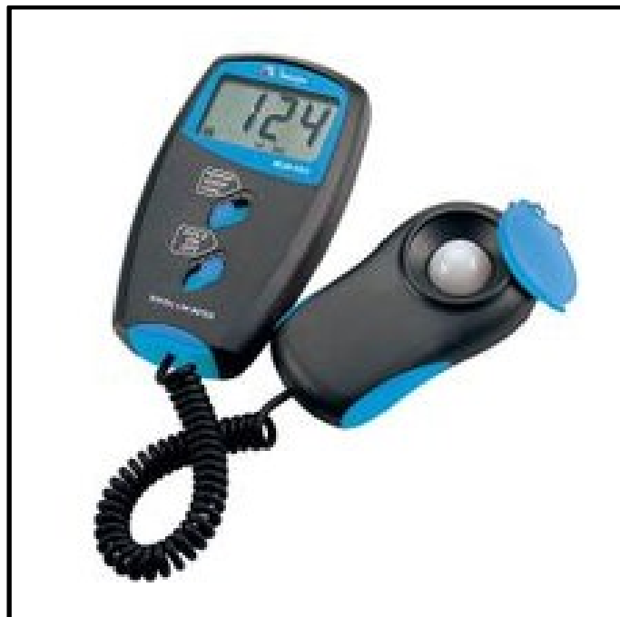
Fig. 13 – Modelo de luxímetro utilizado no diagnóstico
