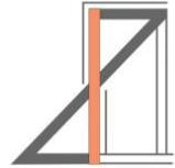
Este material é colocado sobre outro de preenchimento da junta - espuma de poliuretano ou similar - que funciona como cofragem e apoio à colocação do material elástico que deverá ser autonivelante.
