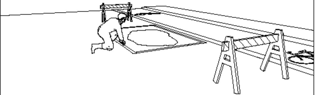
**2º DEMARCAÇÃO DA ÁREA A SER REPARADA:** Identificado o local a ser reparado, deverá ser demarcada a área a ser reparada com tinta ou giz, de forma a que toda a parte comprometida ainda existente venha a ser retirada. Esta marcação deve ser feita com linhas retas, sempre paralelas ao eixo da via e perpendiculares ao mesmo. Não deve ser permitida a abertura da cava com bordos arredondados.
