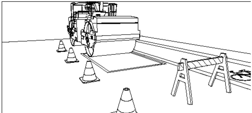
**10º CAMADA DE REVESTIMENTO:** CBUQ é o revestimento flexível resultante da mistura a quente, em usina apropriada, de agregado mineral graduado, material de enchimento (filler) e material betuminoso, espalhada e comprimida a quente. A espessura mínima permitida da camada de massa asfáltica é de 5,00 cm aplicada. A execução dos serviços de pavimentação asfáltica com CBUQ, deverá ser de acordo com as Normas Técnicas, incluso projeto de dosagem de mistura asfáltica do CBUQ.
