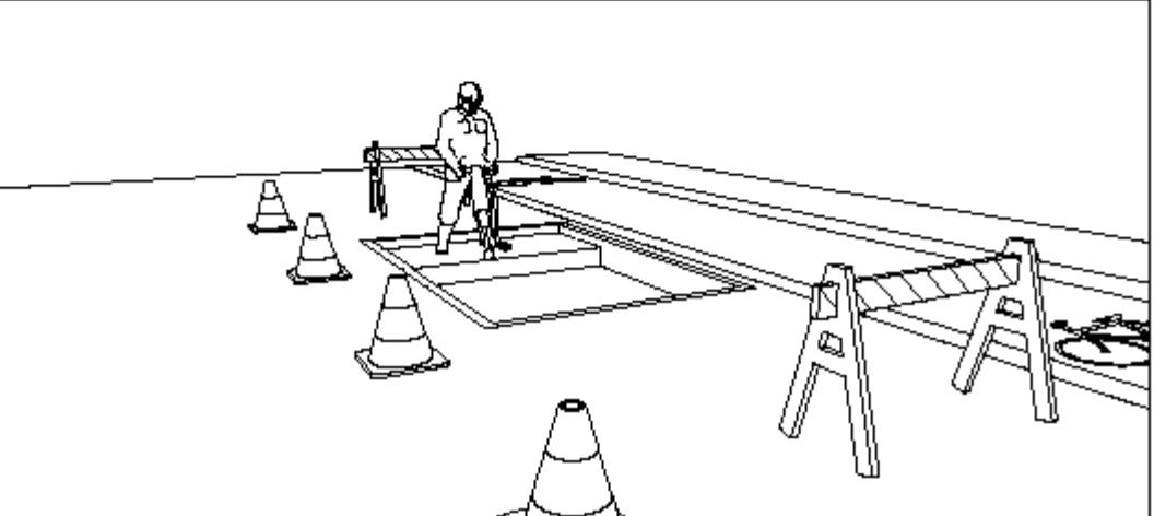
**3º CORTE MECANIZADO:** O serviço consiste requadrar em figuras geométricas (retângulo ou quadrado), a área afetada e cortar a capa asfáltica mecanicamente, para que as bordas fiquem perfeitas.
