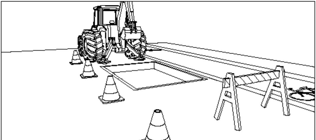
**5º ESCAVAÇÃO:** O serviço consiste em escavar, carregar e transportar para um local de "bota-fora", designado pelo município, todo o material que não apresente características granulométricas e de compactação exigidas para servir de base de pavimento asfáltico.
