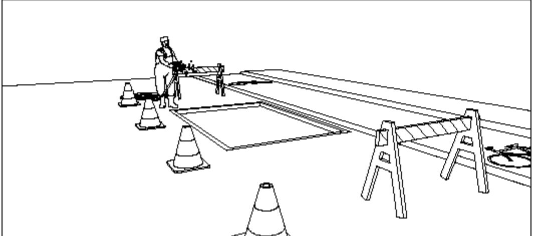
**8º IMPRIMAÇÃO:** Impermeabilização com a aplicação de uma película de material betuminoso sobre uma superfície granular concluída de uma das camadas do pavimento. Cura média, CM-30. O material betuminoso não deve ser distribuído quando a temperatura ambiente estiver abaixo dos 10°C, ou em dias chuvosos, ou quando esta estiver eminentemente. Qualquer falha na aplicação do material betuminoso deve ser imediatamente corrigida.
