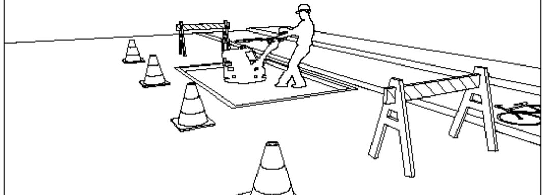
**6º BASE:** De acordo com as Normas Técnicas: NB-1337/91, EB-2096/91 Em todas as intervenções terá a necessidade de melhoria da base, onde será utilizada uma base de bica corrida com classificação A2 (ASTM D3282). Nos serviços de preparação da base, deverá ser feito em camadas de no máximo 20,00 cm, compactados através de compactadores manuais de placa vibratória, progressivamente das bordas para o centro, até atingir o grau de compactação de 95% do PROCTOR MODIFICADO.
