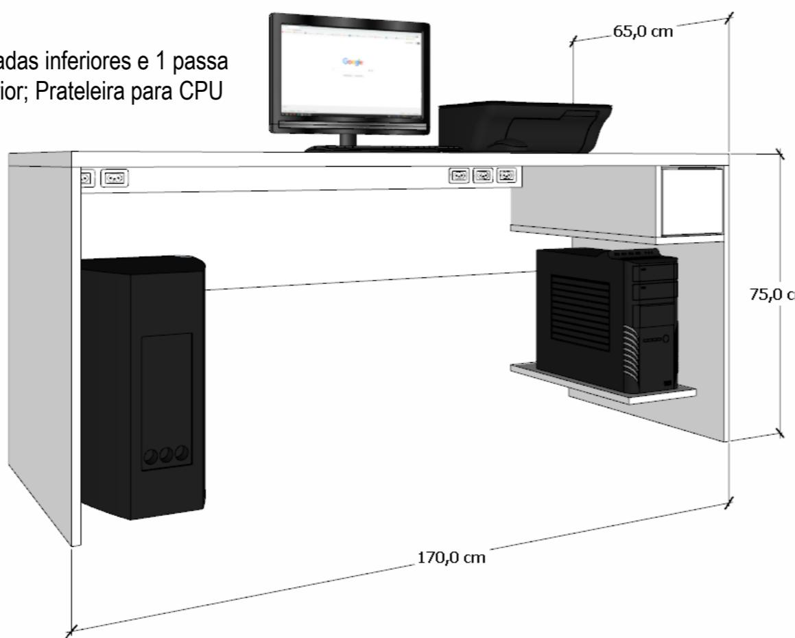
02 Bancadas em estrutura metálica 30mm, pintura eletrostática preta, com tampo em MDF Maxi Branco
