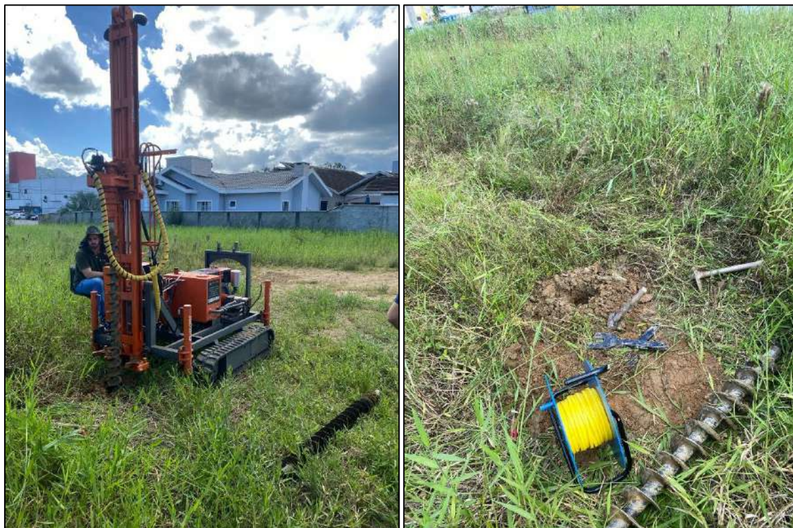
Figura 1a e 1b – perfuratriz utilizada na execução das sondagens e broca e equipamento de medição utilizados.
