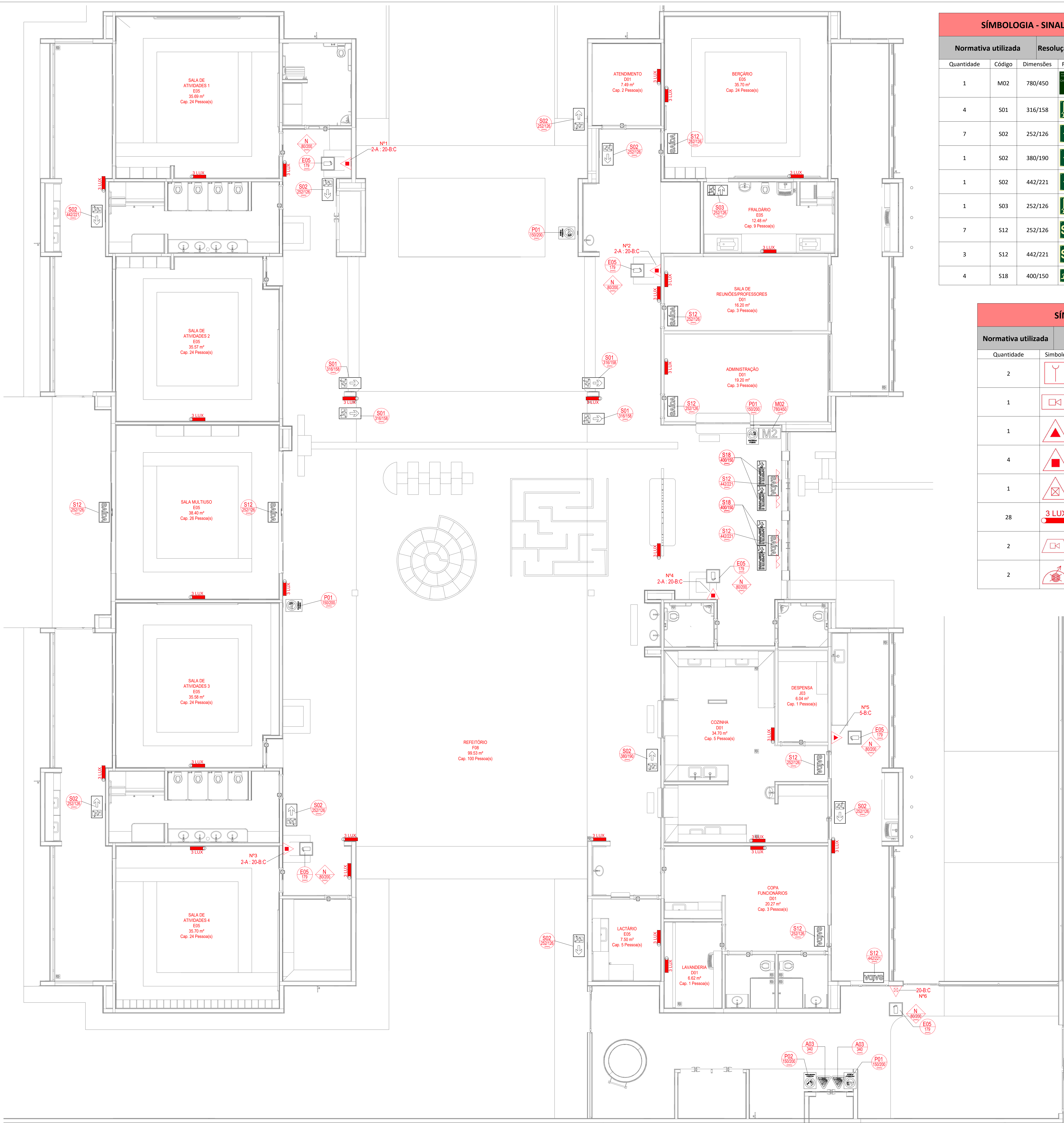
Planta Baixa - Extintores, Sinalização e Iluminação
